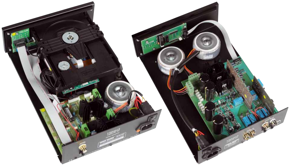
Beide Obelisk-Geräte haben ordentliche Stromversorgung und einen überhaupt sehr durchdachten Aufbau auf der Habenseite
